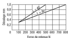
Les forces s'appliquent aux éléments carrés en acier ou en inox
